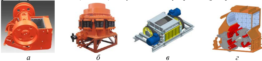
Рис.3. Обладнання для дроблення: а – щоківі(щелепна) дробарка; б – конусна дробарка; в – валкова дробарка; г – дробарка ударної дії.
