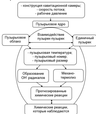
Рис. 1. Упрощенная теоретическая схема кавитационного процесса гидродинамической кавитации
