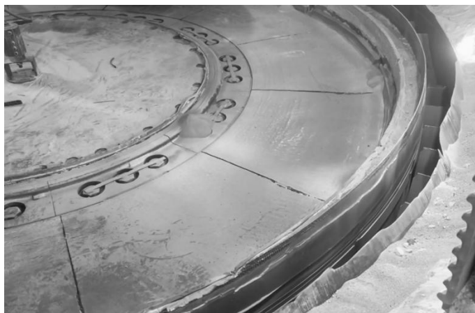
Рис.2. Характер зношування поверхні помольного столу
