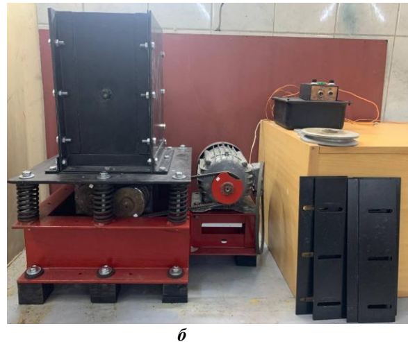
Рис.4. Розрахункова схема (а) та вібраційна установка (б) для проведення експериментальних досліджень робочого процесу ущільнення бетонної суміші.
